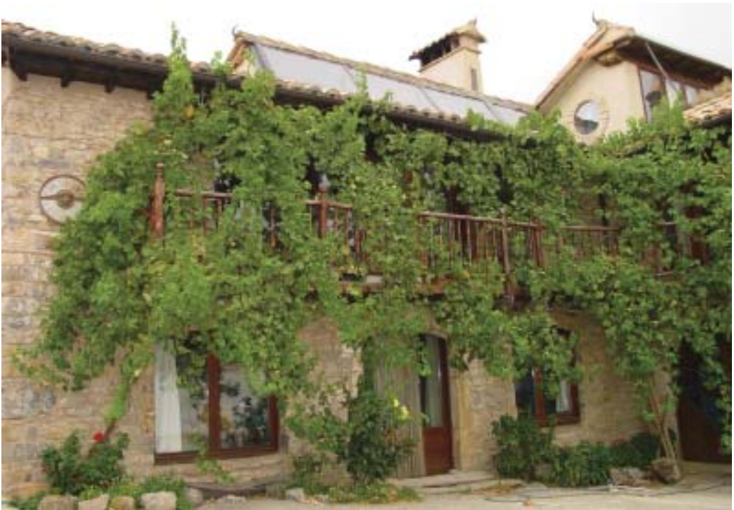
Un exemple de bioconstrucció integral en la qual s'empren materials naturals, s'incorporen elements vegetals en el seu disseny i es doten de sistemes d'energia solar passiva i termosolar.
